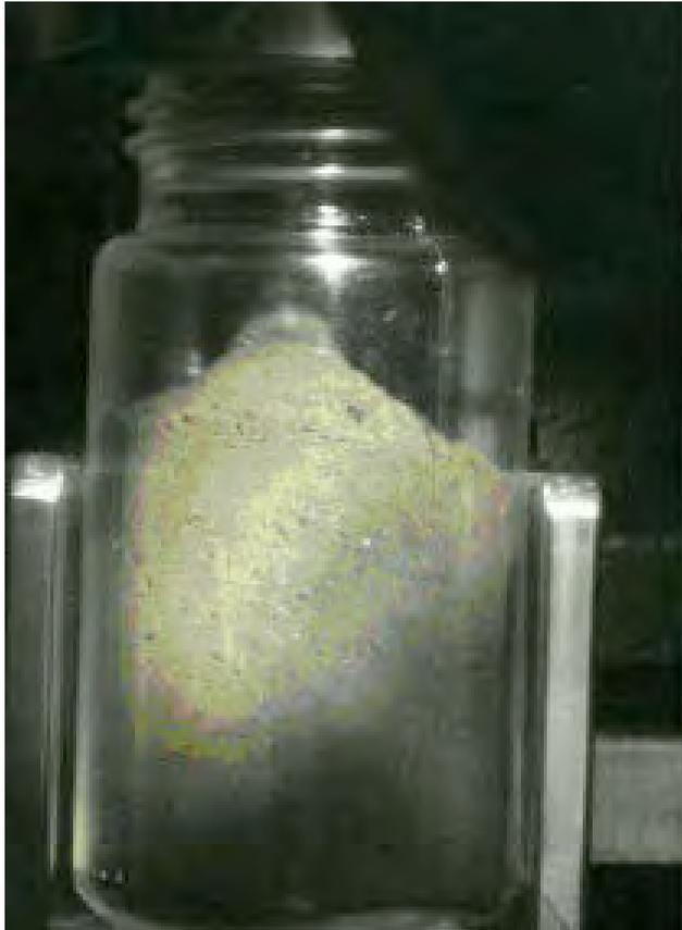
日本原燃は16日、試運転（アクティブ試験）中の使用済み核燃料再処理工場（青森県六ヶ所村）で、プルサーマル発電の燃料となるプルトニウム・ウラン混合酸化物（MOX）製品の生産を開始したと発表した。同日午後3時半、プルトニウムを半分含むMOX粉末を、製品第一号となる粉末缶に充てんし、計量を終えた。粉末缶は一個当たり約12キロで、3個1組で貯蔵容器で保管する。再処理工場では2日から、プルトニウムとウランの混合硝酸溶液からマイクロ波加熱で硝酸を飛ばす脱硝工程を行い、最初のMOX粉体の取り出しに成功。その後、焙焼（ばいしょう）や粉砕など、微小な粉末にする作業を続けていた。来夏まで予定するアクティブ試験中に使う使用済み燃料は430トンで、4トン強のプルトニウムが抽出される見込み。
