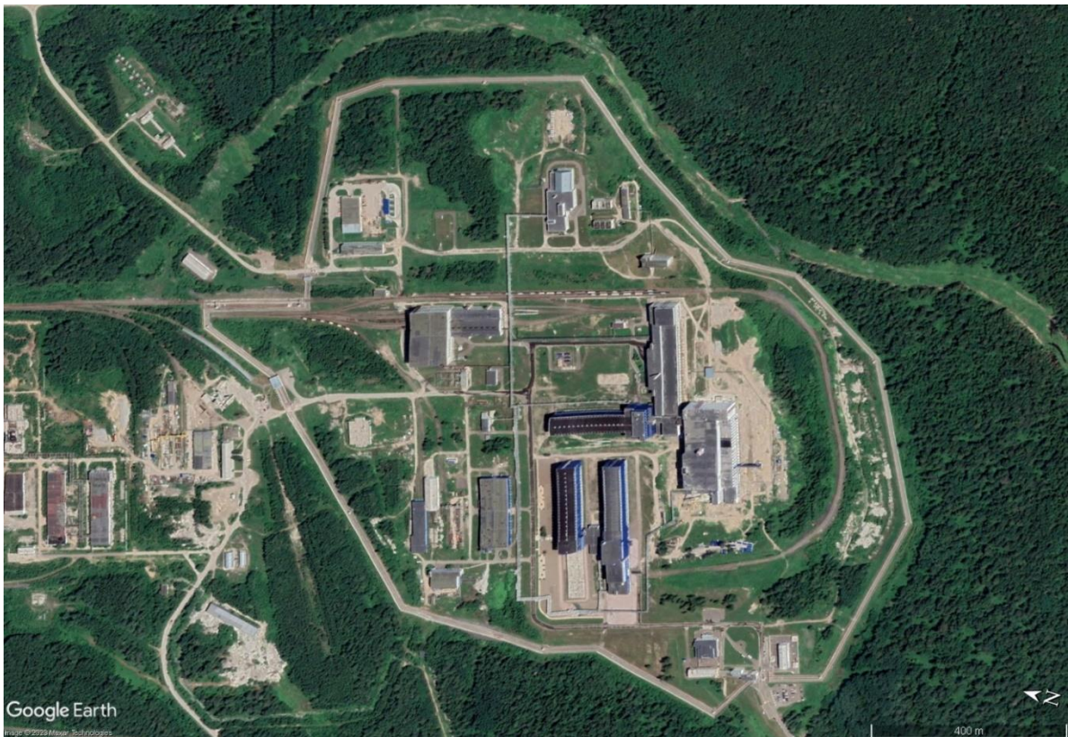
図 6 ジェレズノゴルスク郊外にあるロシアの使用済み燃料貯蔵・民生用再処理サイトは、3重防護フェンスで囲まれている。北側から入っている線路(写真上部)上の列車に載せられた使用済み燃料輸送キャスクが見える(この縮尺では白い破線状)。使用済み燃料貯蔵建屋は二つのグループに分かれていて、それぞれ、燃料受け入れ用のプールを備えている。合計貯蔵容量は、プール貯蔵合計8600トン、乾式貯蔵3万7800トン。2013年時点でのロシアの原子炉の年間排出量にして70年分だ。右側の建物は、このサイトにあると報じられている新しいパイロット再処理施設だ。出典: Google Earth image, 13 July 2021. 94
