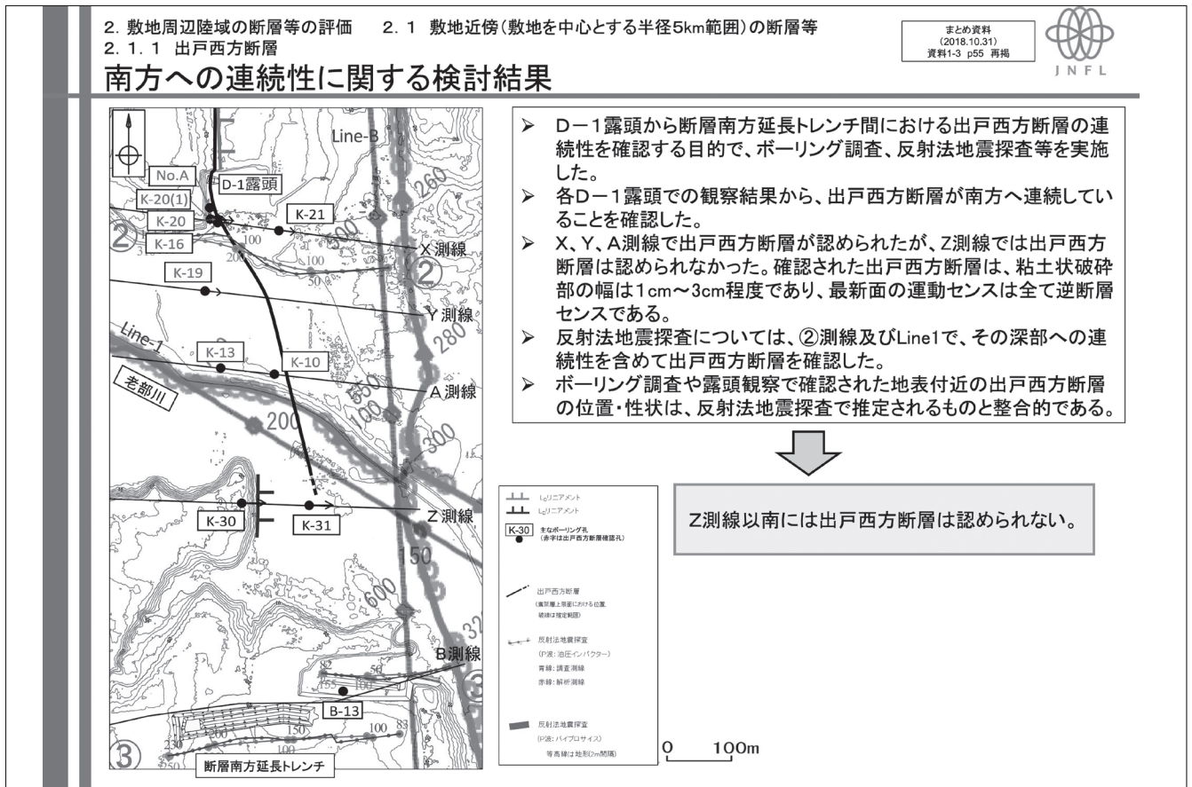
図3 出戸西方断層の南端部をめぐる調査（日本原燃2020より）
